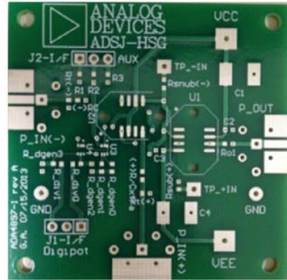
图 6. 放大器评估板，包含数字电位计连接
